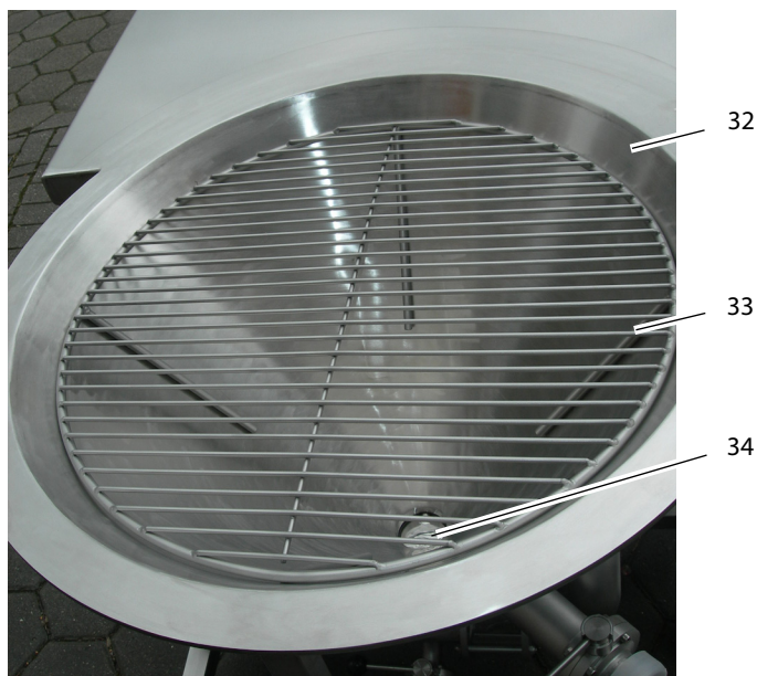
Fig. 10 Tolva con rejilla
